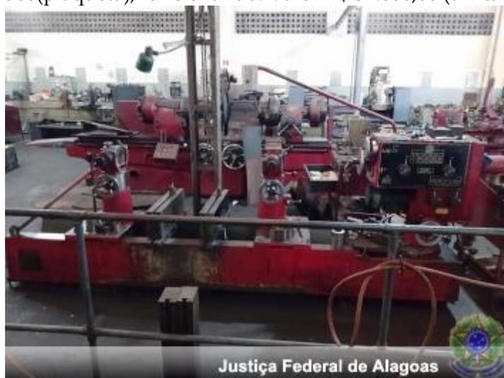
d) - Uma máquina alinhadora de mancais de bloco de motor marca AMC MOBIL DTE light, nº 482, L-1500(plaqueta), funcionando. Valor R\$ 37.000,00 (trinta e sete mil reais)
