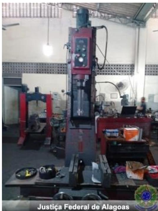
c) - Uma máquina alinhadora de mancais de bloco de motor marca AMC MOBIL DTE light, nº 431, L-1500(plaqueta), funcionando. Valor R\$ 37.000,00 (trinta e sete mil reais)
